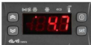
Рис. 5 Панель управления и контроля
